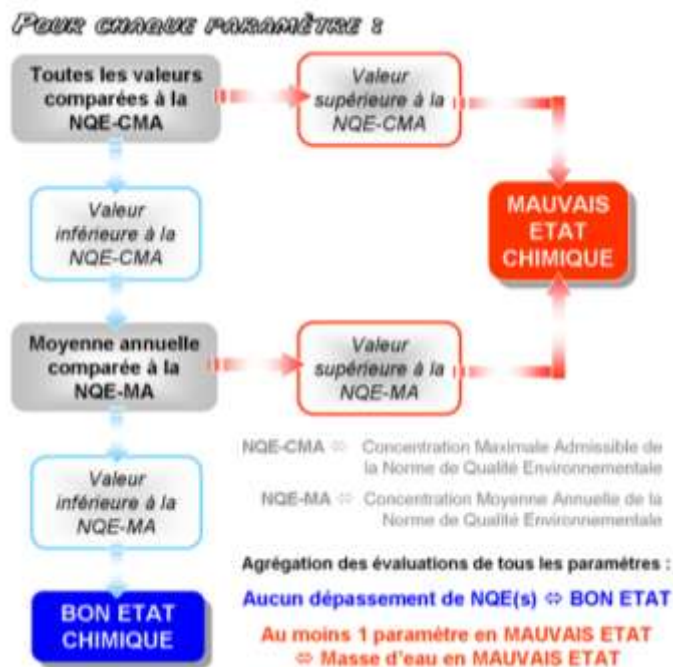
Figure 42 : Schéma du mode d'agrégation des résultats pour les contaminants chimiques dans l'eau (source : Ifremer., 2014)
